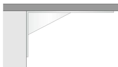
Abstützung z.B. mittels Trägerplatte
