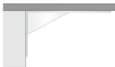
Abstützung z.B. mittels Konsole
